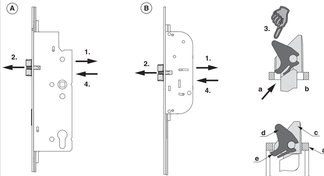
1.) Schraube vollständig lösen und mit Schraubendreher nach vorne drücken.
